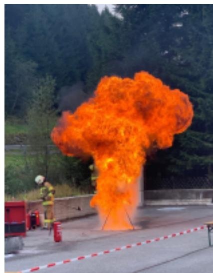
Ein mit Wasser gelöschter Fettbrand löst eine Explosion mit Riesenerweiterung aus.
