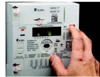
Bei Wiederinbetriebnahme einer Anlage wird der Smart Meter vom Netzbetreiber aus der Ferne auf "bereit zur Wiedereinschaltung" aktiviert. Aus Sicherheitsgründen muss der Zähler (ausgenommen Zählertausch) vor Ort durch den Kunden selbst in Betrieb genommen werden.
